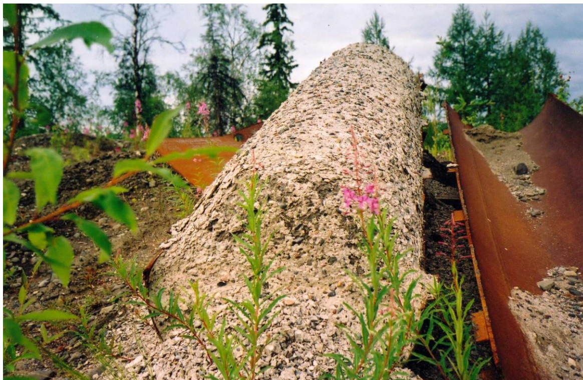
Фото 1.4.1 - Образец глиноцементобетона, пролежавший 4 года на открытом воздухе
