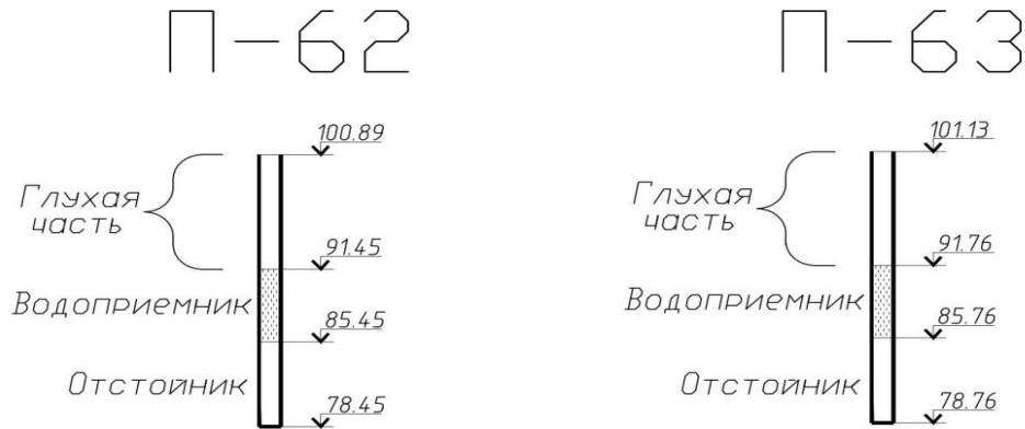
Рисунок 1.3.6 - Геометрические параметры пьезометров П-62 ПК 9+00 НБ-2,66 м и П-63 ПК 9+49,78 НБ-2,38 м
